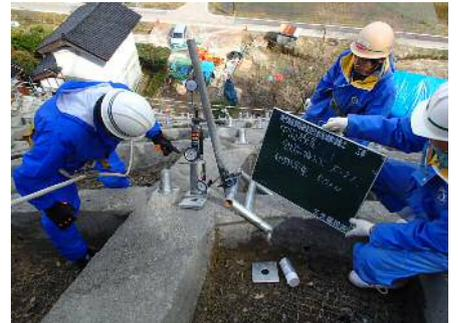
鉄筋挿入工引抜試験
