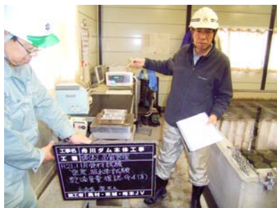
骨材吸水率、乾燥重量段階確認
